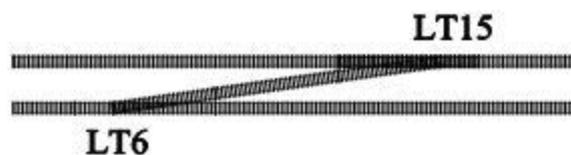
Pour des routes normales, les aiguillages 6 et 15 sont en position fermée. Pour le croisement, les aiguillages 6 et 15 sont en position déviée. Maintenant supposons que nous voulions simplement envoyer une commande à l'aiguillage 6 pour sélectionner les routes.
