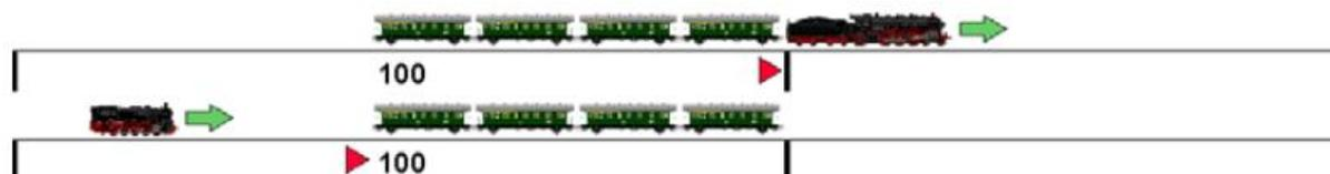
Ces formules sont utiles pour le changement de locomotives, quand la nouvelle locomotive s'arrêtera à l'arrière des voitures attendant et les longueurs des locomotives impliquées dans le changement peuvent être différentes. Avec la première formule, la première voiture du train entrant est arrêtée à 100 pouces. Avec la deuxième formule, la nouvelle locomotive est déplacée de l'autre côté à la fin des voitures attendant. Cela fonctionne même si la locomotive originale reste dans le canton.
