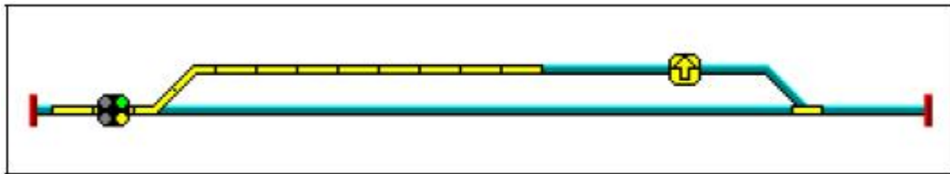
Figure 50 : Route Active avec l'aiguillage et le signal
